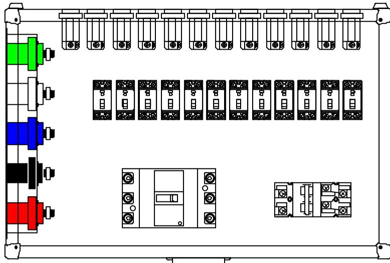
すべての接続を確認後、電源供給されましたら受電電圧を測定し異常なければ主遮断器を「ON」にしてご利用下さい。
